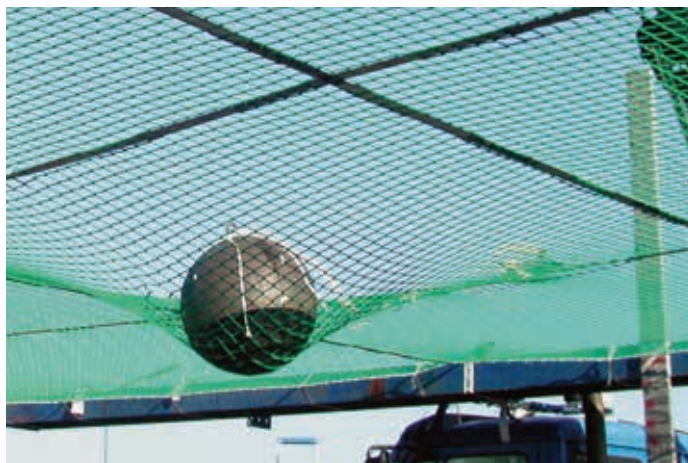
Sítě jsou upínány pásy podél a napříč v rámu 2 x 2 m.
