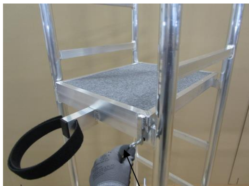
Pro uvolnění podestové desky povolte očkové šrouby na obou stranách
